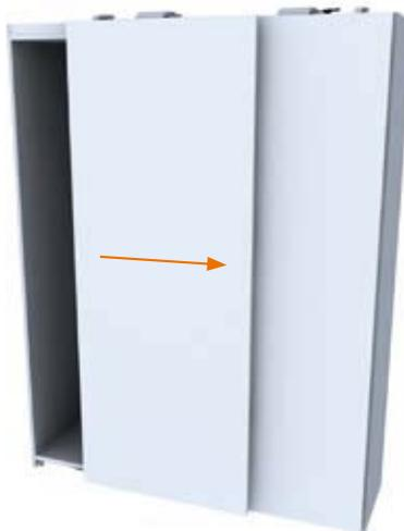
23) Расположите на двери измерительный инструмент (уровень) между двумя регулировочными пластинами. С помощью эксцентриковых регулировок в пластинах А и В добейтесь правильного расположения дверей. Закройте левую дверь. Повторите операции для правой двери.
