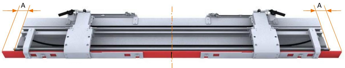
6) Верхнюю направляющую защелкнуть в клипсах на верхней панели шкафа (Рис 8, 9А и 9В).
