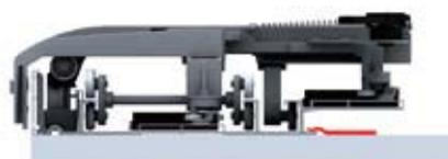
7) Верхнюю направляющую окончательно закрепить слева и справа на верхней панели шкафа, начиная слева – это необходимо для корректного позиционирования направляющей.
